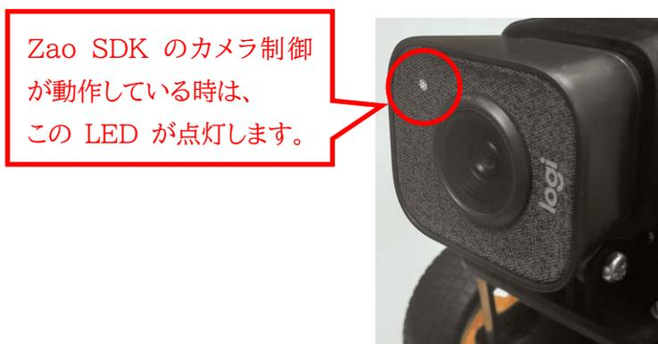
図 3-5 USB カメラの LED
