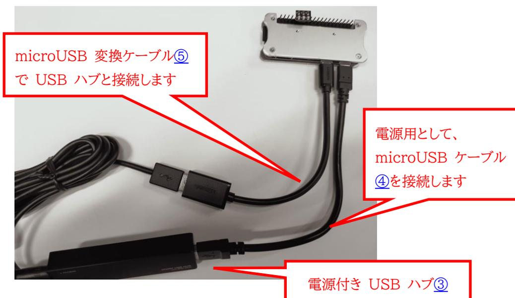
図 4-4 Raspberry Pi Zero と USB ハブの接続
