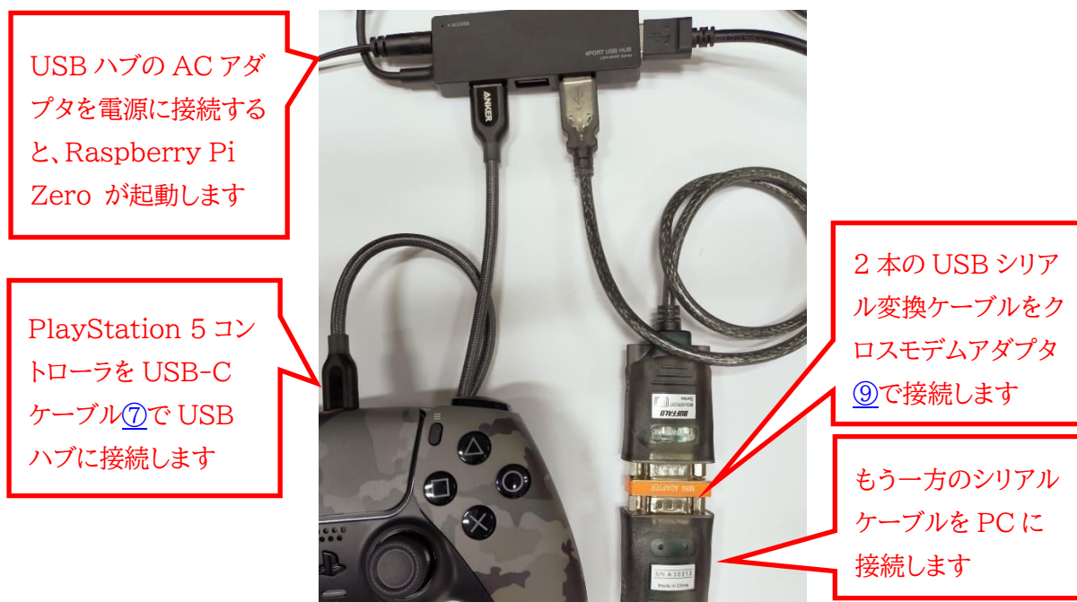
図 4-5 PlayStation 5 コントローラ、シリアルケーブルの接続
