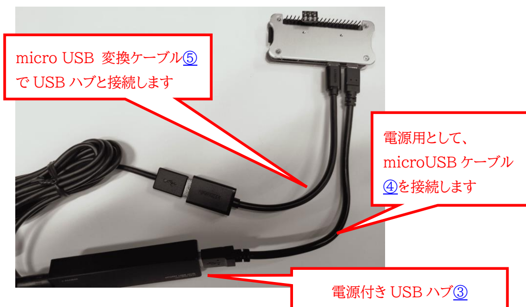
図 4-4 Raspberry Pi Zero と USB ハブの接続
