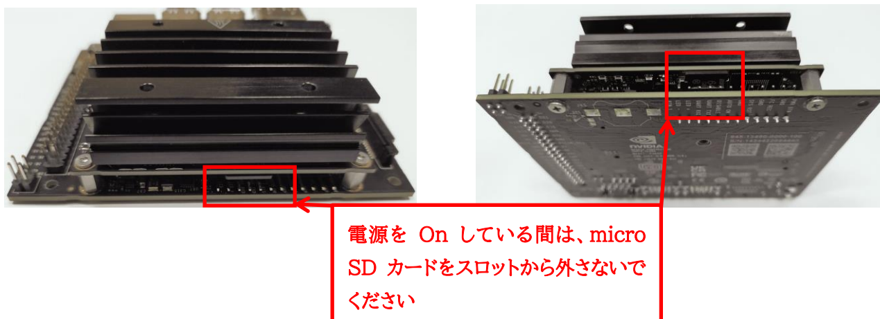
図 2-11 Jetson Nano の micro SD カード
