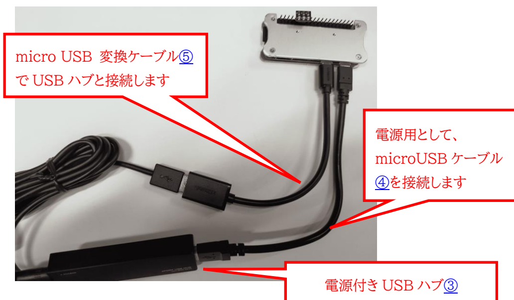
図 4-4 Raspberry Pi Zero と USB ハブの接続
