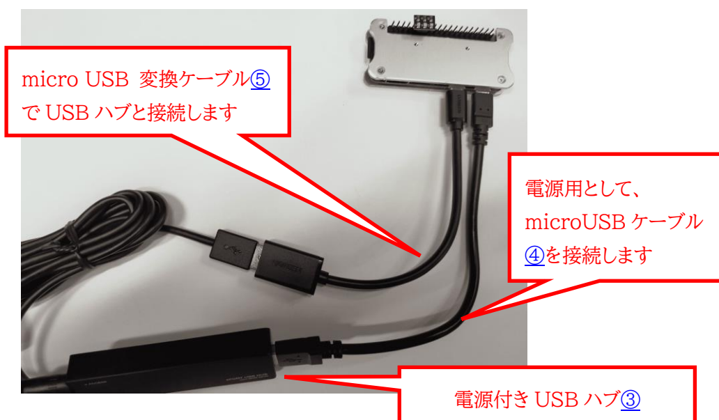
図 4-4 Raspberry Pi Zero と USB ハブの接続
