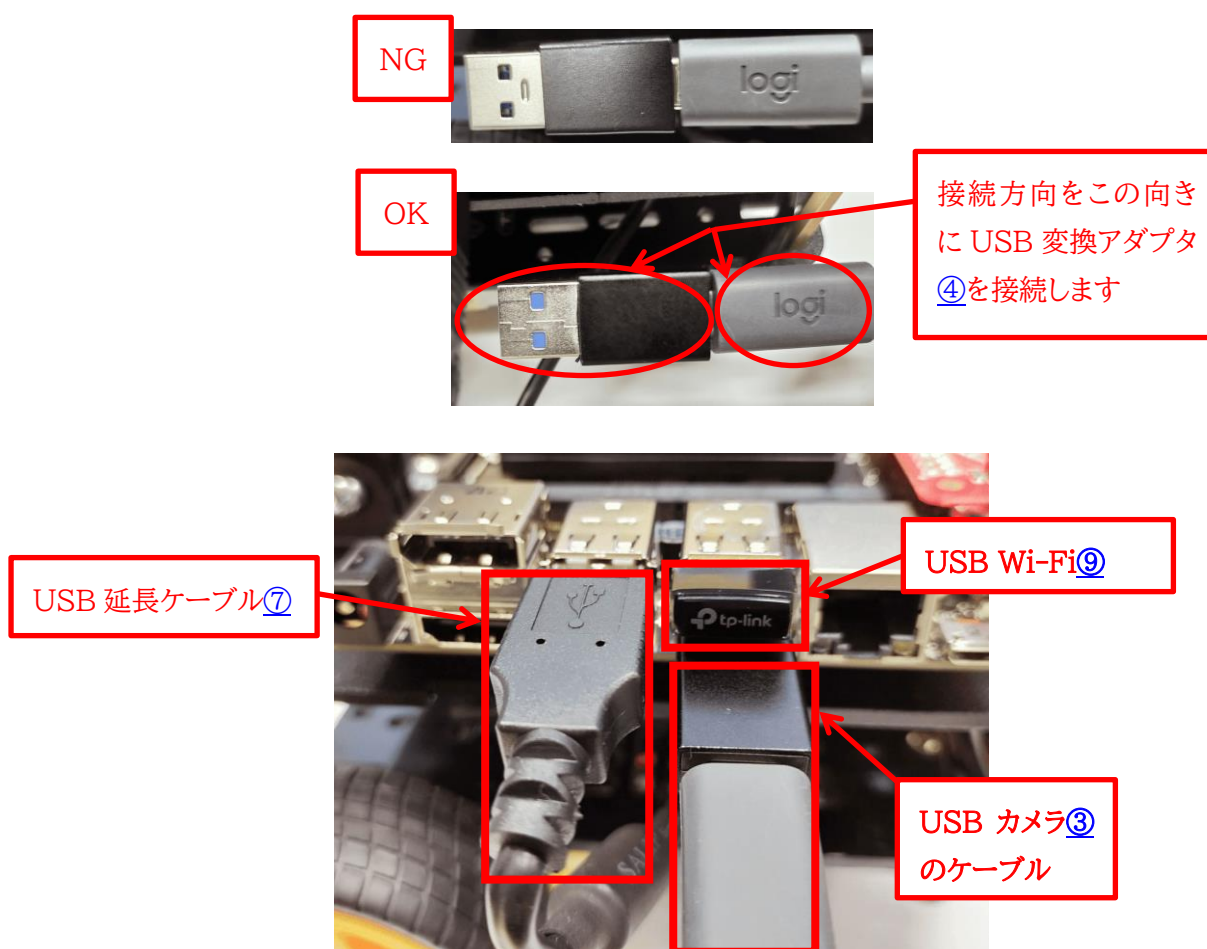
図 2-20 Jetson Nano との USB 接続
