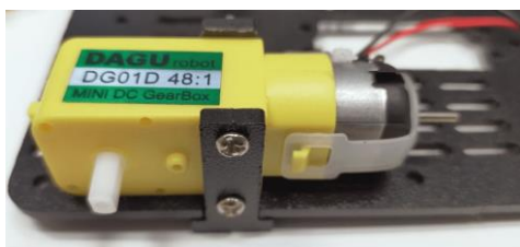
図 2-3 モーターのネジ止め
